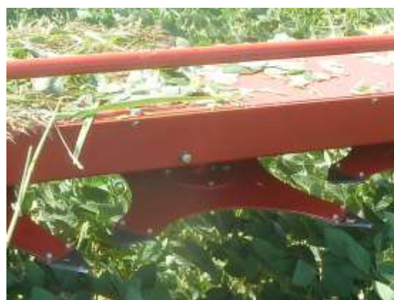
Fig. 5. Organi di taglio della cimatrice. Dettaglio
