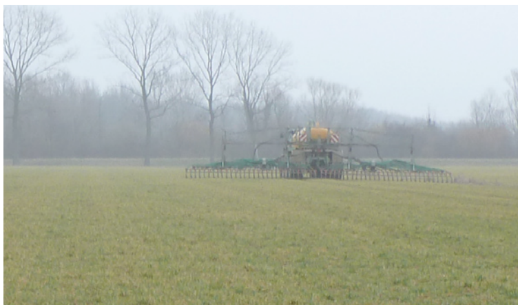
Foto 2. Distribuzione liquami con barra dotata di assolcatori. Data 23-02-2017 (S. Bortolussi)
